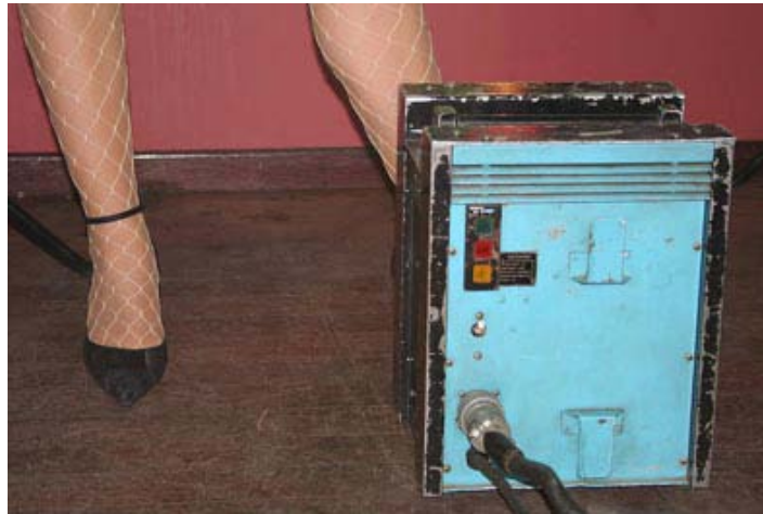
Slika 91: Obločnice za svoje delovanje potrebujejo težak transformator Vir: lasten
