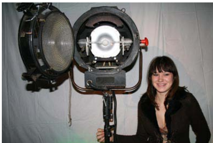
Slika 95: Rokovanje z žarnico pri obločnicah zahteva posebno pazljivost
