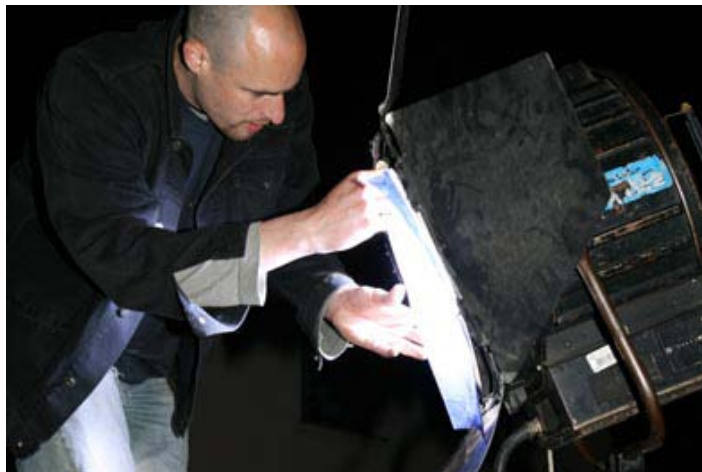
Slika 94: HMI-jeve obločnice so težke in okorne
